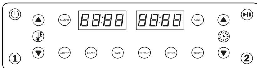
Po pripojení teplovzdušnej fritézy k elektrickému napájaniu a po jeho aktivácii sa ozve zvukové znamenie a rozsvieti sa vypínač, ktorý ukazuje, že zariadenie je pripojené k napájaniu.
