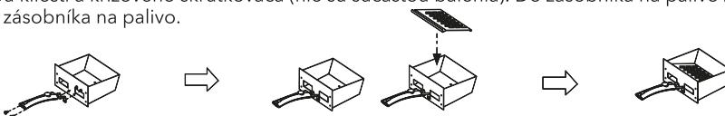
**7. KROK:** Pomocou 3 skrutiek a 3 matíc zostavte lopatku na pizzu. Utiahnite pomocou klieští a krížového skrutkovača.
