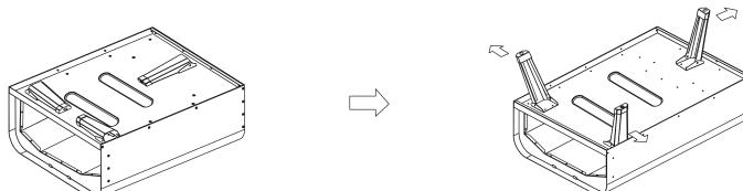
**2. KROK:** Pec na pizzu obráťte a položte ju na stabilný, žiaruvzdorný povrch. Umiestnite rukoväť na hornú časť a zarovnajte upevňovacie otvory. Vložte 2 skrutky a utiahnite ich krížovým skrutkovačom (nie je súčasťou dodávky).
