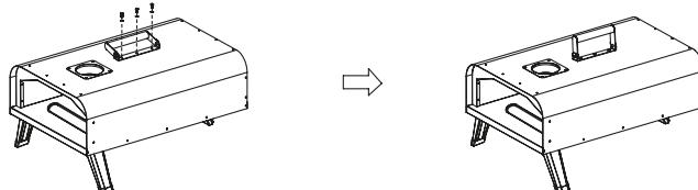
**3. KROK:** Umiestnite kryt komína na hornú časť komína a vložte 1 skrutku. Na skrutku na vnútornej strane komína nasadte 1 maticu. Utiahnite pomocou klieští a krížového skrutkovača.
